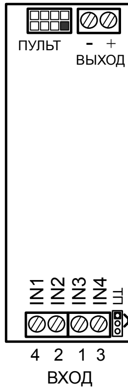
Рисунок Б.8 - Расположение клемм и разъёма для подключения пульта программирования на плате преобразователя НПТ-2Ц.Р.0.0.42
